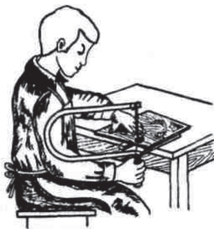
Рис. 2.12. Позиція працюючого при випилюванні
