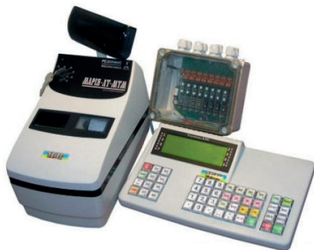
Рис. 1.5. Інформаційні машини: а – касовий апарат; б – машина для захисту (кодування) інформації
