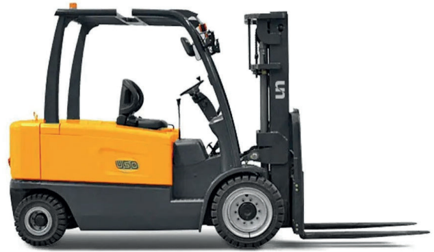
Рис. 1.4. Транспортні машини: а – гвинтовий конвеєр; б – електронавантажувач
