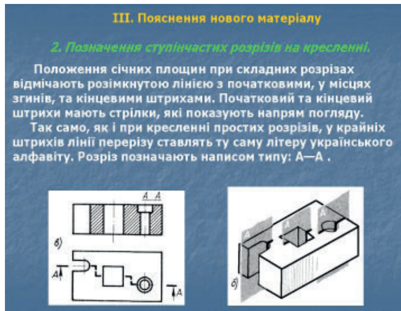
Рис. 3.3. Позначення ступінчастих розрізів на кресленні
