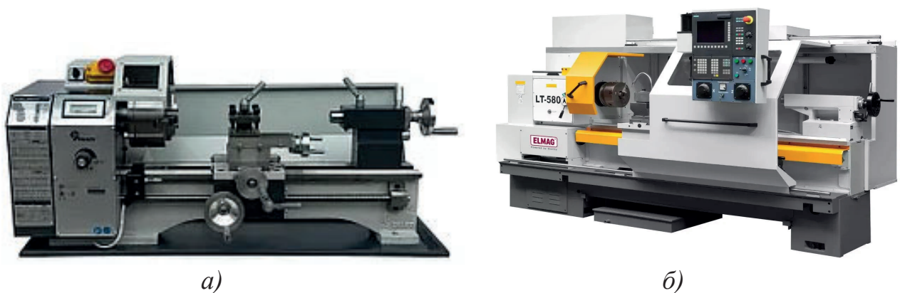
Рис. 1.4. Види токарних верстатів: а – з ручним керуванням; б – з числовим програмним керуванням (ЧПК)
