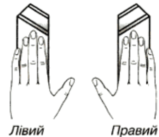
Рис. 1.3. Класифікація різців за напрямом подачі
