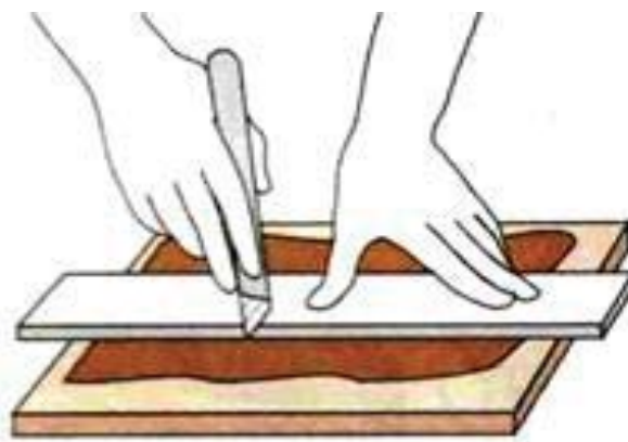
Рис. 2.9. Рівняння країв із допомогою металевої лінійки
