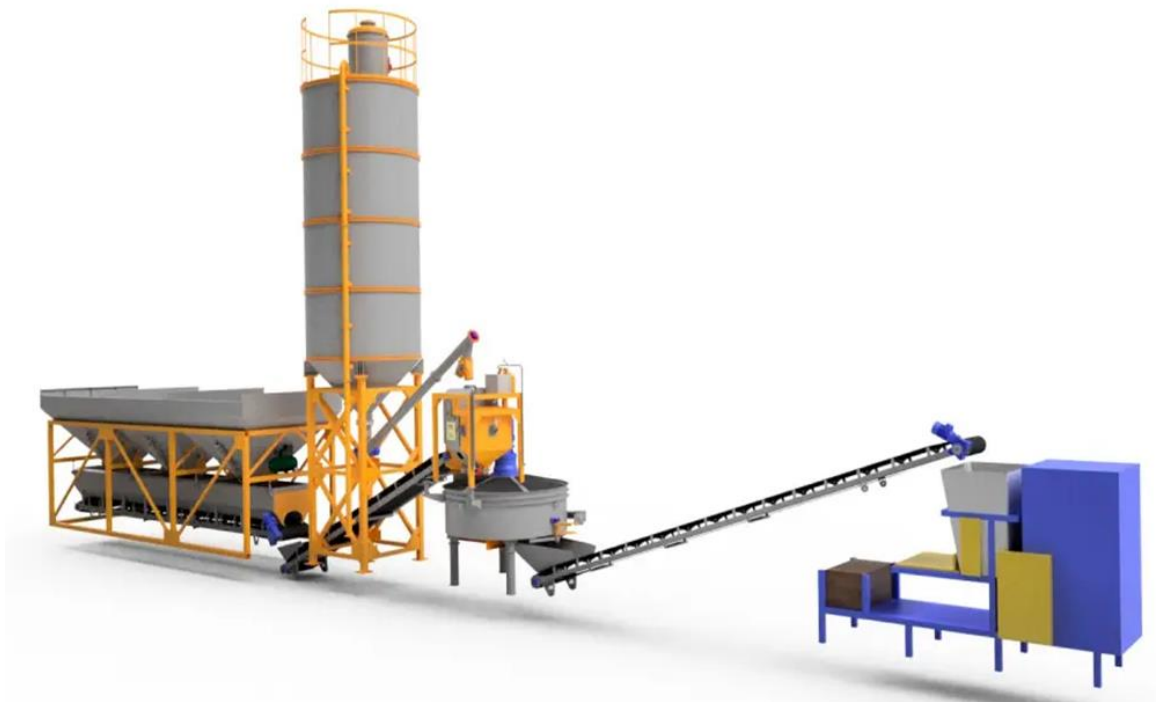
Рис. 3.2. Розчино-бетонний вузол PRINZING-PFEIFFER GmbH.
