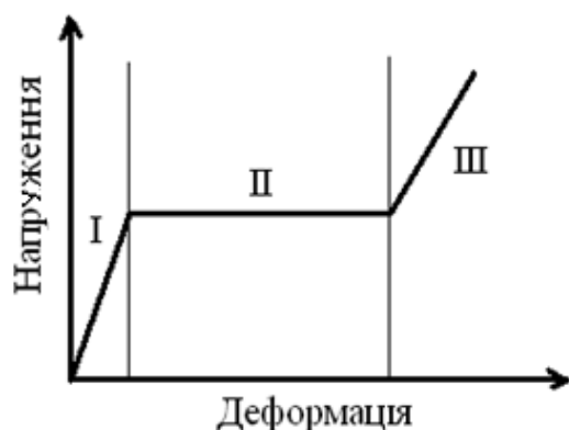
Рис. 3. Залежність напруження від деформації для кристалічного лінійного полімеру
