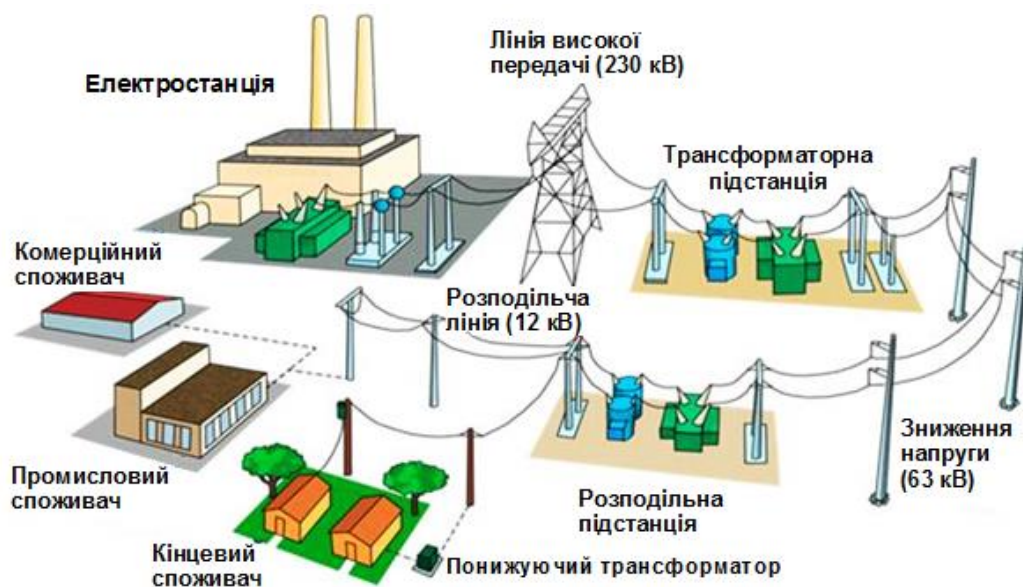
Рис. 1. Трансформатори в системі транспортування електричної енергії
