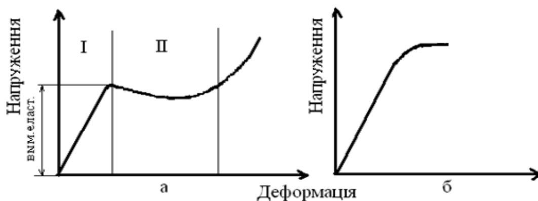
Рис. 2. Діаграми розтягування: а – склоподібного полімеру; б – полімеру з щільною сітчастою структурою, I – область пружних деформацій; II – область вискоеластичної деформації
