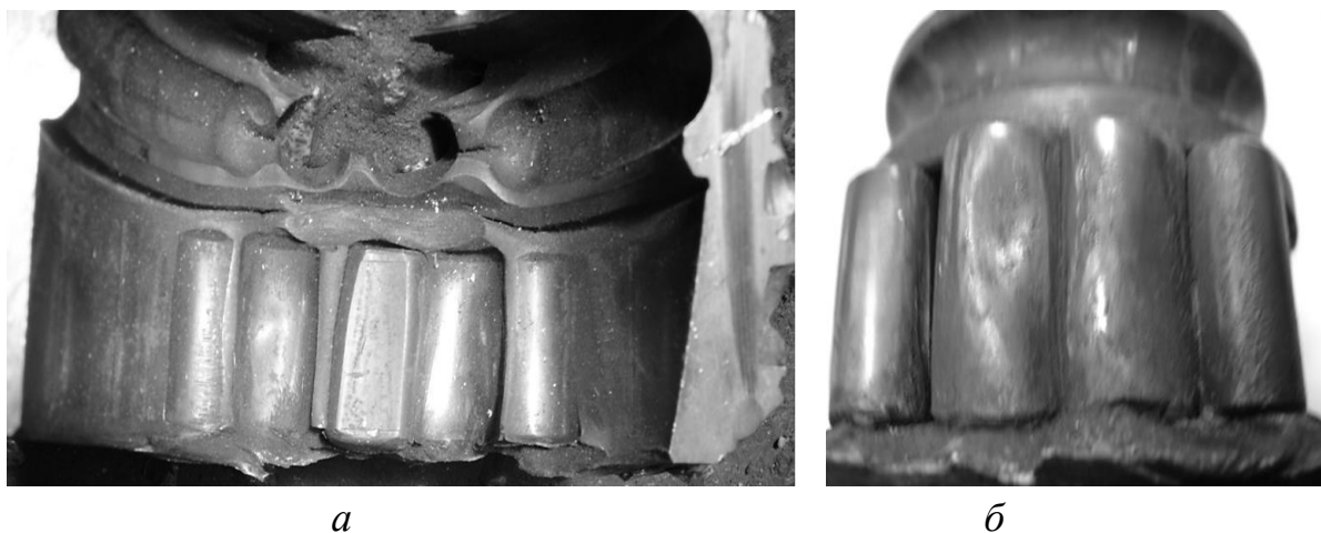
Рисунок 1 – Загальний вигляд катастрофічного руйнування шарошки в ділянці великого роликового та замкового кулькового підшипників (а) та характер руйнування роликового ряду на цапфі лапи в навантаженій зоні (б) гірничорудного бурового долота
