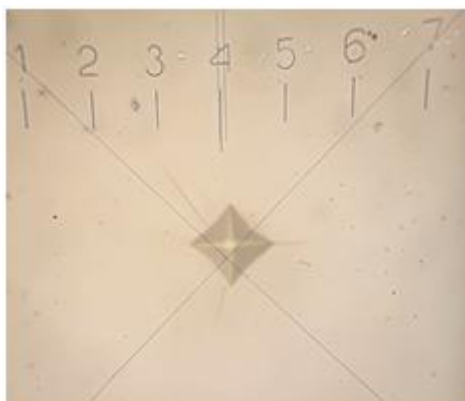
Рис. 2. Тріщини на вихідних зразка CdZnTe
