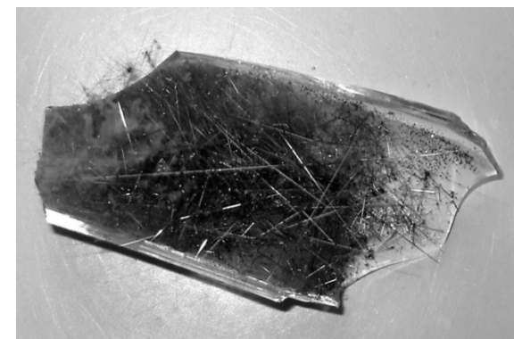
Рисунок. 1. Вигляд ампули з вирощеними ниткоподібними кристалами SiGe
