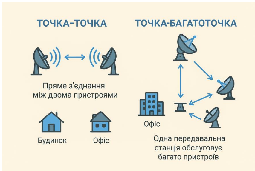
Рис 6.2 Схеми роботи бездротової мережі точка-точка та точка-багатоточка
