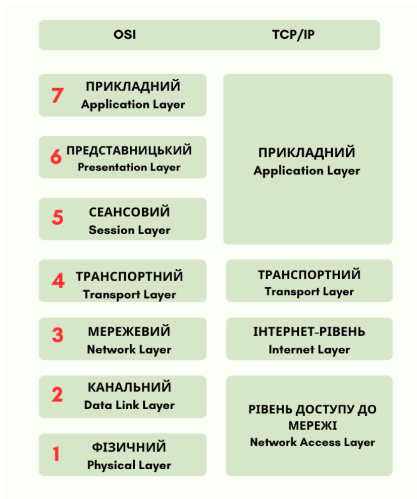
Рис 2.3 Схема моделі OSI з описом функцій кожного рівня
