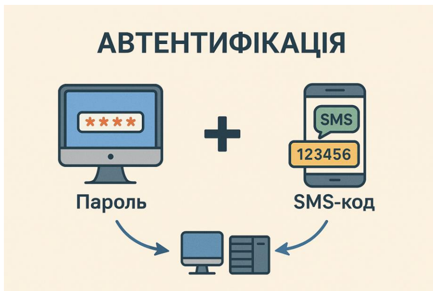
Рис 7.2 Схема двофакторної автентифікації – пароль + SMS-код
