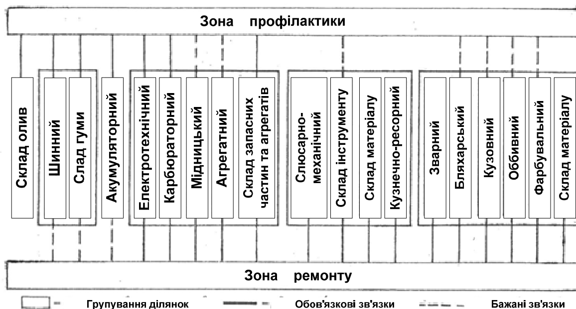
Рис. 3.7. Групування виробничих ділянок і їх зв'язки з основними виробничими зонами
