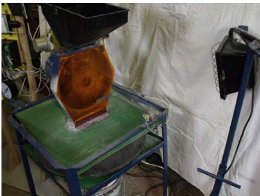
Рис. 6.2. Вібраційна роторна дробарка з поєднанням процесів подрібнення матеріалів і вібрації:
