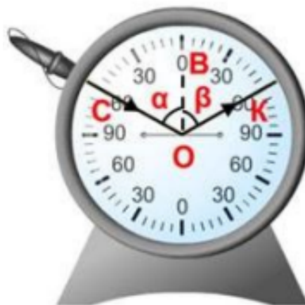
Рис.1.5. Шайба Гартля для демонстрації падаючого і відбитого променів
