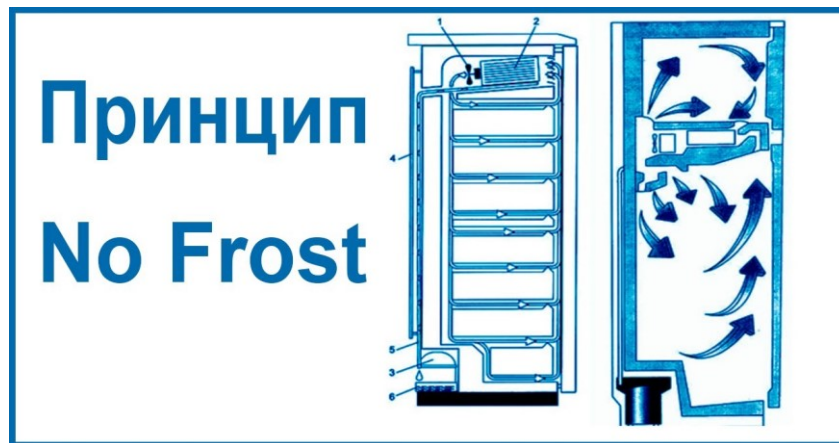
Рис. 2. Принцип роботи холодильника No Frost
